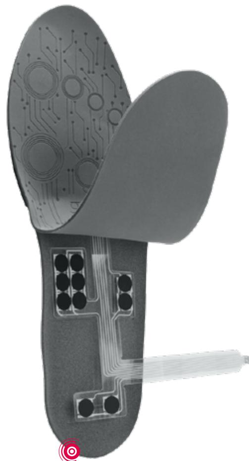
*Exemple de semelle orthopédique imprimée en 3D et intégrant des capteurs de pression.
